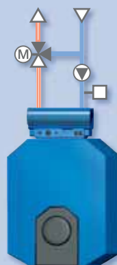
Funkcia regulátora Logamatic 4212 s prídavným modulom ZM427
